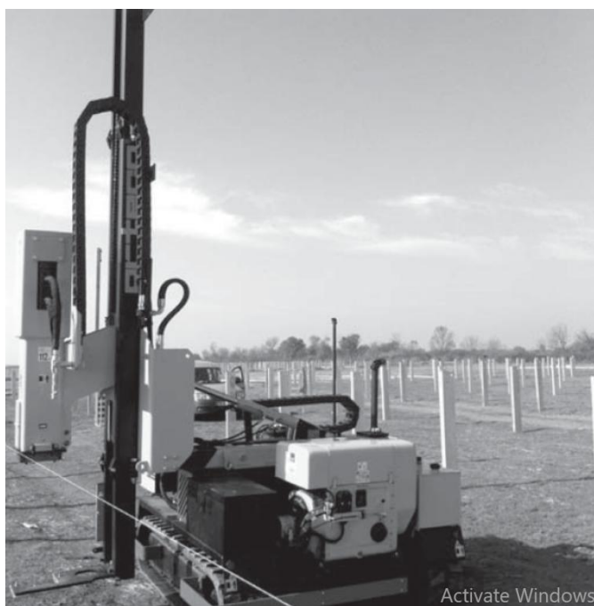
Фигура 31. Машина за хидравлично набиване на вертикалните носещи елементи
